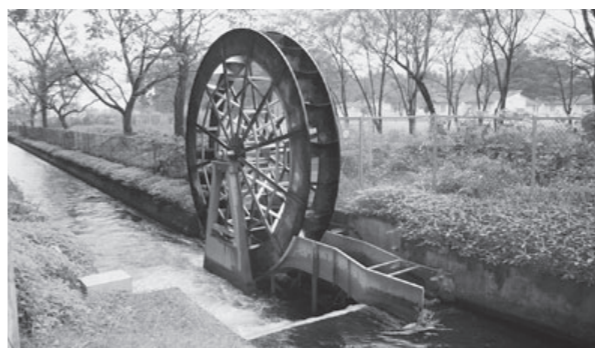
「ガラガラ水車」発電量1.8kw
