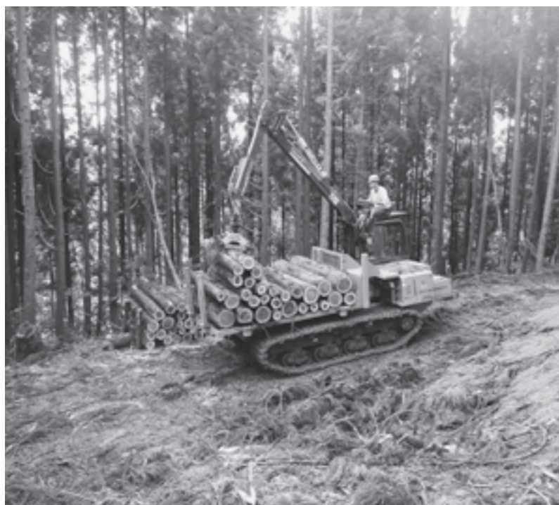
▲高性能林業機械「フォワード」による木材搬出作業
